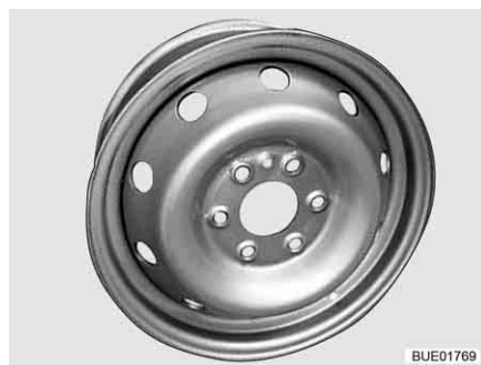
Fig. 173 Cerchione in acciaio (serie)
