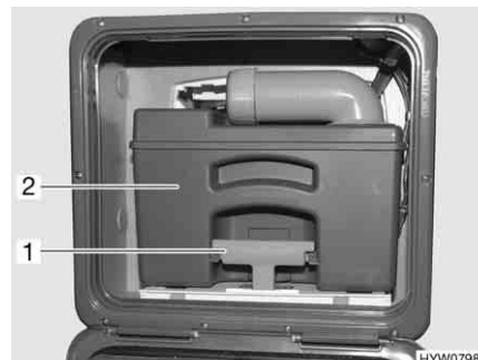
Fig. 159 Serbatoio fecale (esempio)
