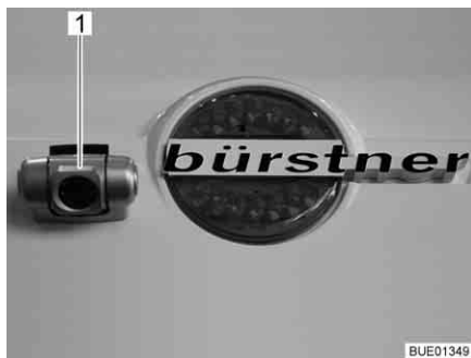
Fig. 10 Telecamera retromarcia con luce a infrarossi
