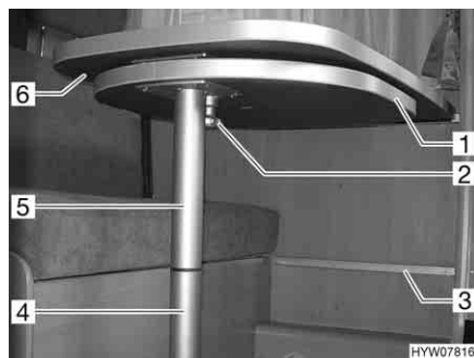
Fig. 72 Tavolo sospeso con piede di sostegno scomponibile
