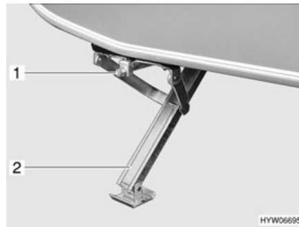
Fig. 18 Piedini di stazionamento a manovella (abbassato)
