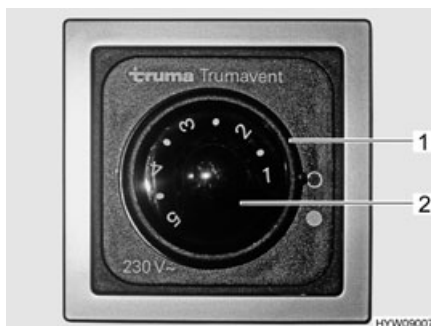
Fig. 93 Interruttore di comando (ventola di ricircolo dell'aria (230 V))
