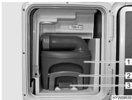
Fig. 127 Serbatoio fecale (nel veicolo)
