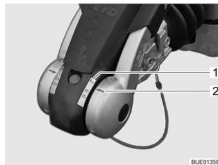
Fig. 2 Controllo "AKS chiuso"
