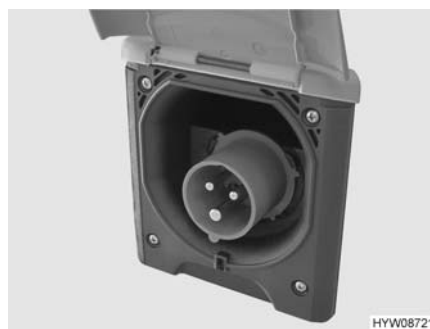
Fig. 84 Collegamento a 230 V al veicolo (presa CEE)
