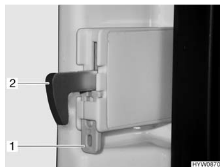
Fig. 116 Dispositivo di fissaggio (gancio di bloccaggio)
