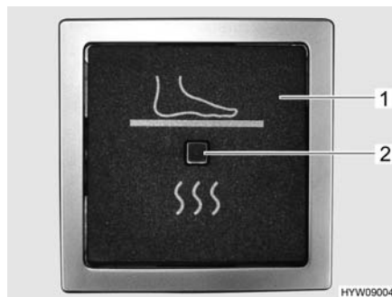
Fig. 106 Interruttore (riscaldamento elettrico del pavimento)
