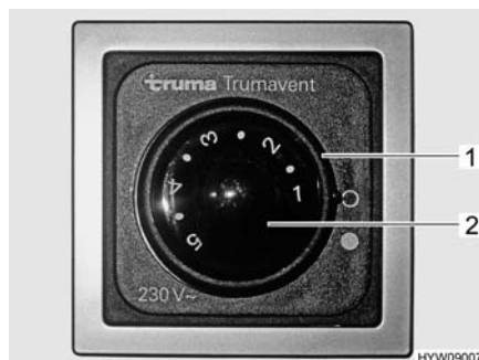
Fig. 101 Interruttore di comando (ventola di ricircolo dell'aria (230 V))
