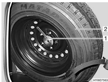
Fig. 146 Supporto per la ruota di scorta
