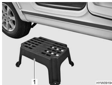
Fig. 21 Scalino di ingresso (non fissato all'interno)
