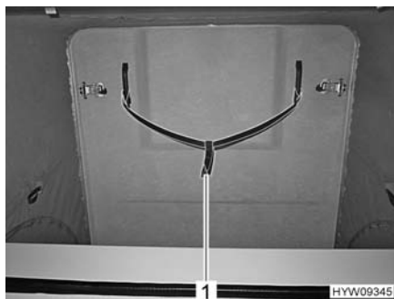
Fig. 52 Cinghia di servizio (tetto a soffietto)
