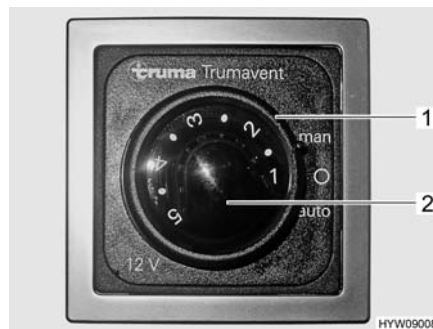
Fig. 102 Interruttore di comando (ventola di ricircolo dell'aria (12 V))
