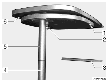
Fig. 60 Tavolo sospeso con piede di sostegno scomponibile
