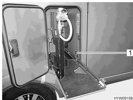
Fig. 80 Base estraibile del vano portabombole in posizione di sostituzione
