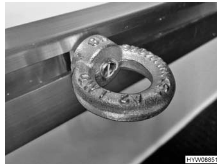
Fig. 3 Occhiello di ancoraggio (serrato)
