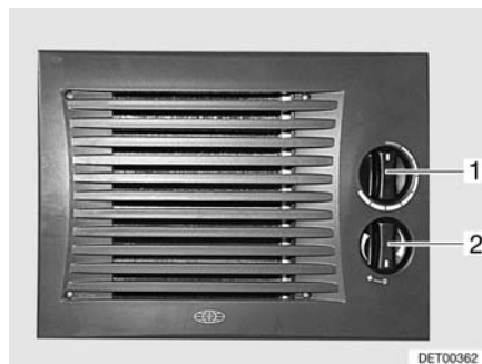
Fig. 119 Elementi di comando (scambiatore di calore aggiuntivo)
