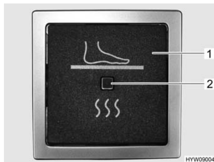
Fig. 117 Interruttore (riscaldamento elettrico del pavimento)
