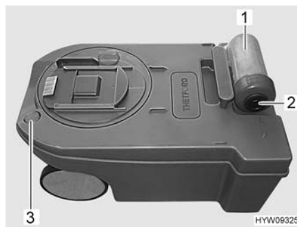
Fig. 169 Serbatoio fecale (alternativa)
