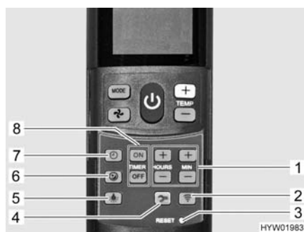
Fig. 122 Telecomando con tasti di impostazione (impianto di climatizzazione)
