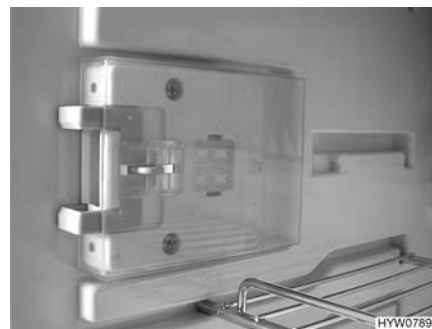
Fig. 153 Dispositivo di chiusura (posizione di ricircolo d'aria)
