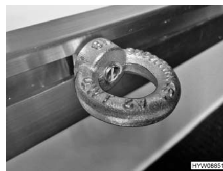
Fig. 3 Occhiello di ancoraggio (serrato)
