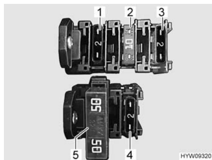
Fig. 114 Fusibili (batteria dell'abitacolo)
