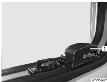
Fig. 128 Interruttore di sicurezza (vista dall'esterno)
