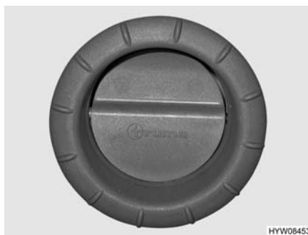
Fig. 123 Bocchetta di uscita dell'aria (riscaldamento ad aria calda)
