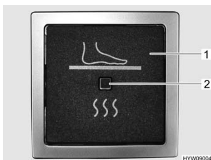
Fig. 130 Interruttore (riscaldamento elettrico del pavimento)
