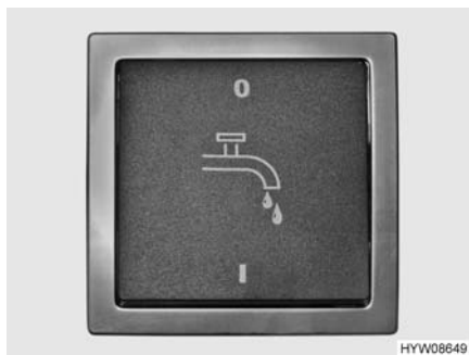
Fig. 160 Interruttore (pompa dell'acqua)
