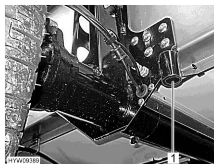
Fig. 231 Punto posizionamento cric (asse posteriore)
