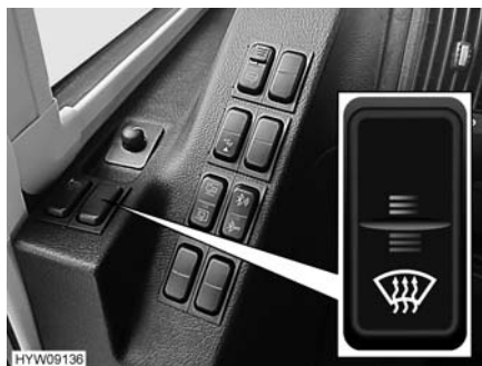
Fig. 7 Interruttore a bilico (riscaldamento del parabrezza)
