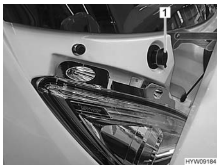
Fig. 35 Bocchettone di riempimento (contenitore dell'acqua di lavaggio)
