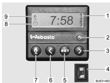
Fig. 163 Centralina di controllo (riscaldamento fisso)
