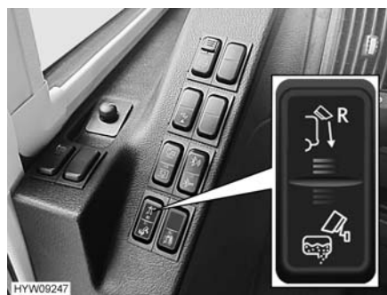
Fig. 189 Interruttore a bilico (telecamera serbatoio delle acque grigie)
