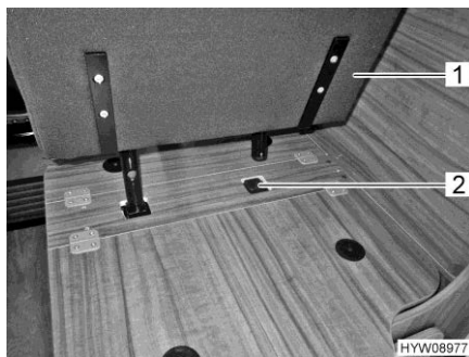
Fig. 27 Inserire il sedile installabile nel supporto
