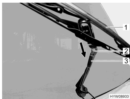
Fig. 215 Sostituzione delle spazzole del tergicristallo
