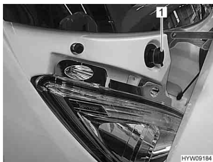
Fig. 43 Bocchettone di riempimento (contenitore dell'acqua di lavaggio)
