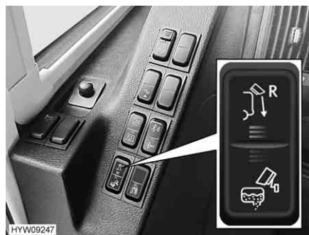
Fig. 37 Interruttore a bilico (modulo telecamere/telecamera serbatoio delle acque grigie)
