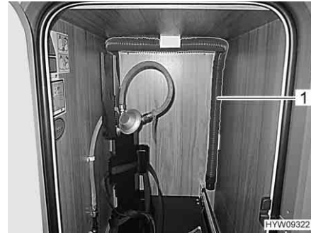
Fig. 205 Tubo di gomma per lo scarico (base estraibile del vano portabombole)
