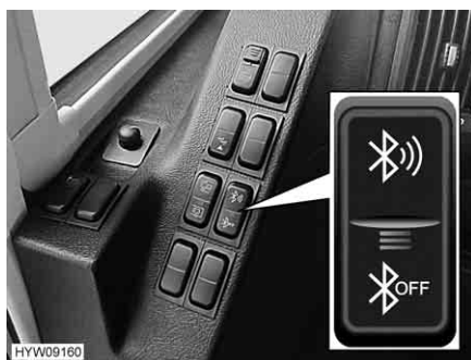
Fig. 126 Pulsante basculante (collegamento Bluetooth)
