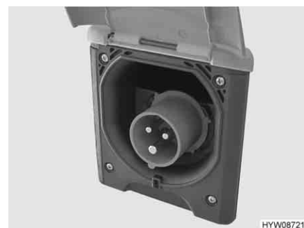
Fig. 134 Collegamento a 230 V al veicolo (presa CEE)
