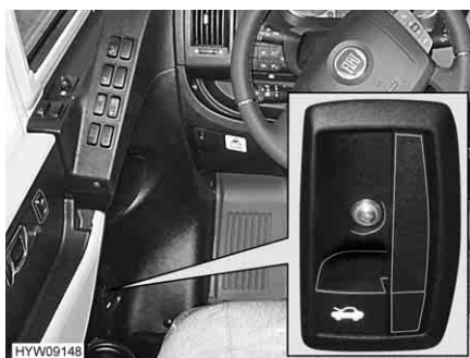
Fig. 41 Leva di sbloccaggio (cofano motore)
