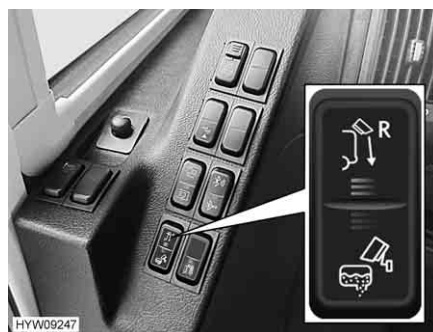
Fig. 202 Interruttore a bilico (telecamera serbatoio delle acque grigie)
