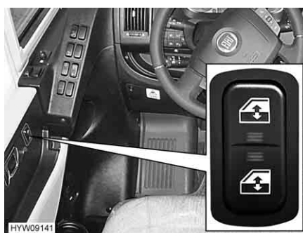
Fig. 33 Interruttore (alzacristalli elettrico nella porta conducente)
