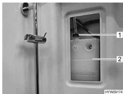
Fig. 224 Vaso d'espansione (riscaldamento ad acqua calda)
