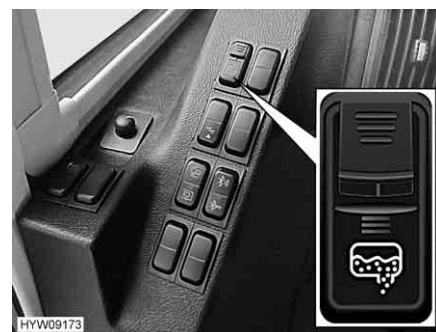
Fig. 203 Interruttore a bilico (scarico delle acque grigie)
