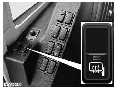
Fig. 35 Interruttore (riscaldamento degli specchietti)
