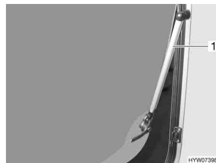
Fig. 64 Finestra apribile con deflettore automatico
