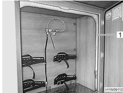
Fig. 204 Tubo di gomma per lo scarico
