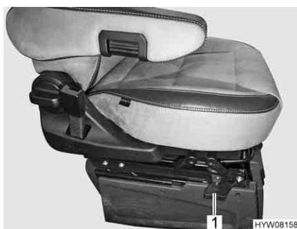
Fig. 80 Leva (rotazione del sedile)
