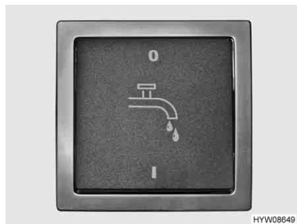
Fig. 196 Interruttore per pompa dell'acqua
