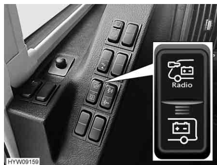
Fig. 125 Selettore (alimentazione elettrica radio)
