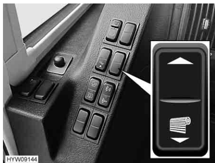
Fig. 39 Pulsante basculante (oscurante a rullo)
