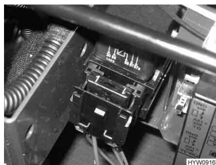
Fig. 144 Fusibile (svuotamento elettrico del serbatoio delle acque grigie)
