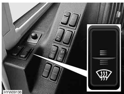
Fig. 9 Interruttore a bilico (riscaldamento del parabrezza)
