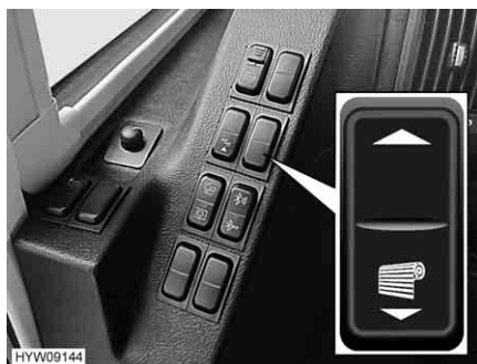
Fig. 69 Pulsante basculante (oscurante a rullo/parasole)
