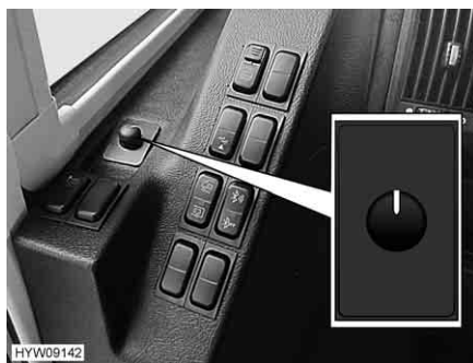
Fig. 34 Interruttore (specchietti esterni a regolazione elettrica)
