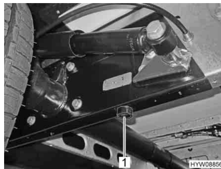
Fig. 246 Punto posizionamento cric (asse posteriore)
