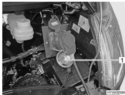
Fig. 51 Collegamento a 230 V
