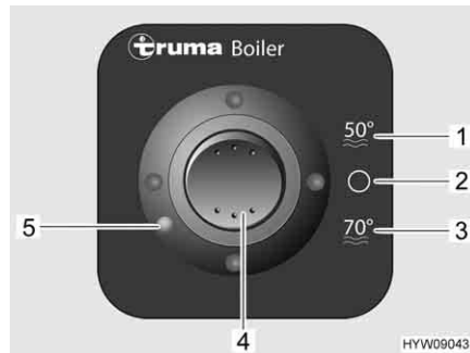
Fig. 96 Frontalino per funzionamento a gas (boiler Truma)
