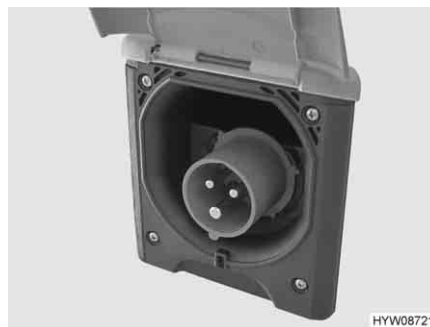
Fig. 77 Collegamento a 230 V al veicolo (presa CEE)
