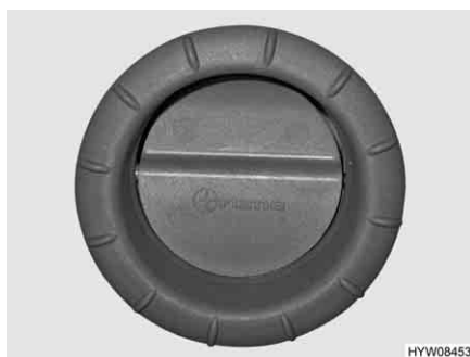
Fig. 88 Bocchetta di uscita dell'aria (riscaldamento ad aria calda)
