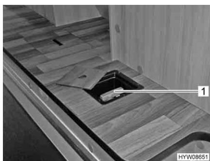
Fig. 116 Leva di comando del serbatoio delle acque grigie
