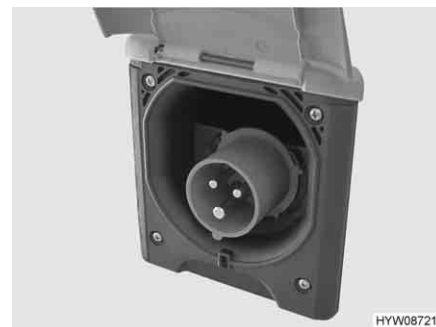
Fig. 85 Collegamento a 230 V al veicolo (presa CEE)
