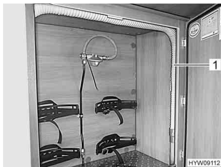
Fig. 114 Tubo di gomma per lo scarico nel vano portabombole
