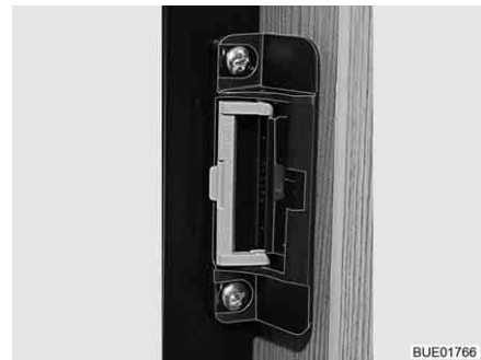
Fig. 110 Dispositivo di chiusura in posizione di ricircolo d'aria
