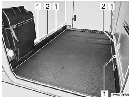
Fig. 3 Occhielli di ancoraggio garage di coda
