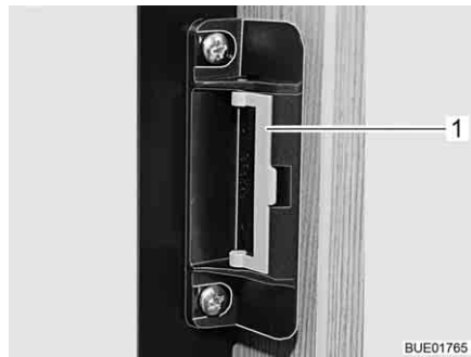
Fig. 109 Dispositivo di chiusura in posizione normale
