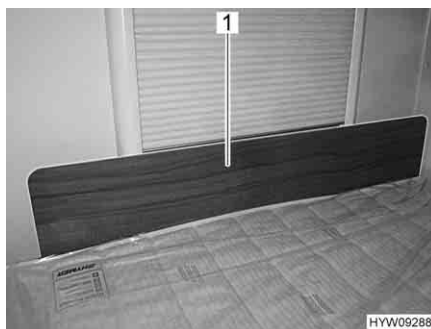
Fig. 72 Pannello di protezione/protezione anticaduta
