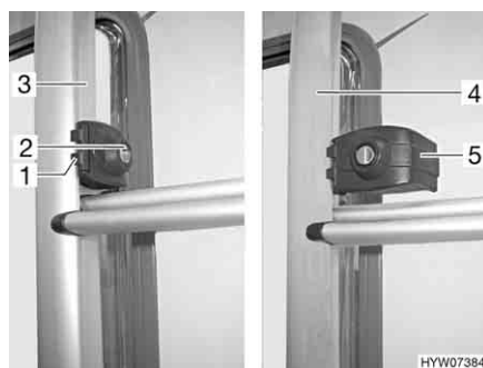
Fig. 2 Bloccaggio della scaletta del portapacchi
