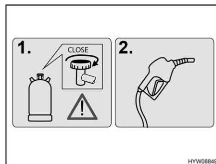
Fig. 20 Avviso (bocchettone di riempimento per il rifornimento di carburante)
