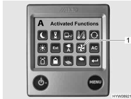
Fig. 117 Funzioni attivate (ventola aggiuntiva)
