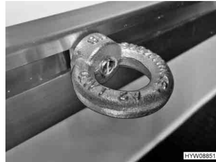
Fig. 3 Occhiello di ancoraggio (serrato)
