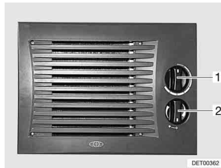
Fig. 113 Elementi di comando (scambiatore di calore aggiuntivo)
