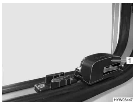
Fig. 109 Interruttore di sicurezza (vista dall'esterno)
