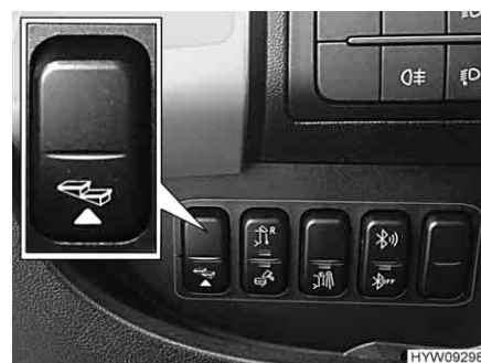
Fig. 6 Interruttore a bilico dello scalino di ingresso (cruscotto)
