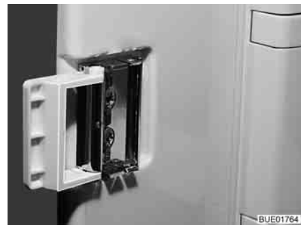
Fig. 149 Dispositivo di chiusura in posizione di ricircolo d'aria
