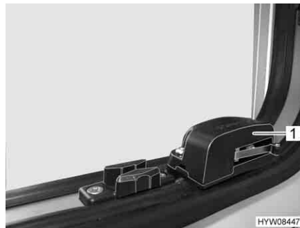
Fig. 122 Interruttore di sicurezza (vista dall'esterno)
