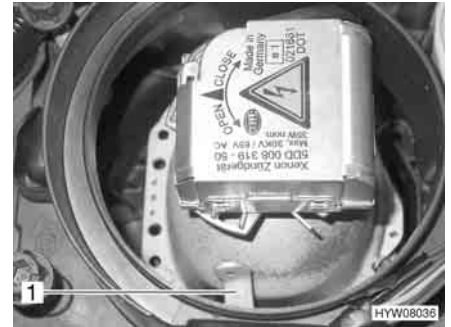
Fig. 227 Conversione fari anteriori (fari Xenon)
