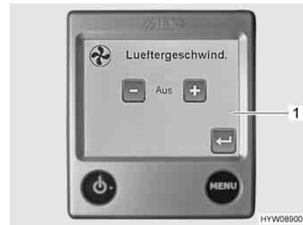
Fig. 152 Comando della ventola aggiuntiva
