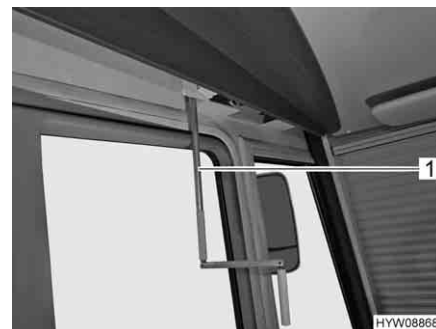
Fig. 62 Manovella per esercizio di emergenza (pronta all'uso)
