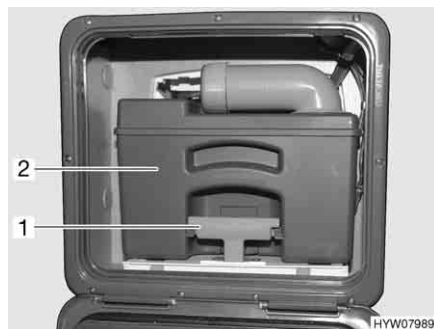
Fig. 195 Serbatoio fecale (nel veicolo)
