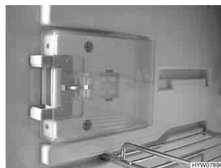
Fig. 111 Dispositivo di chiusura in posizione di ricircolo d'aria
