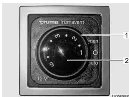
Fig. 96 Interruttore di comando per la ventola di ricircolo dell'aria (12 V)
