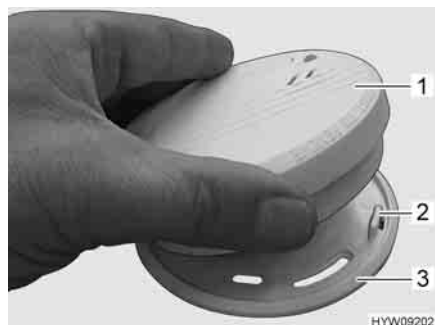
Fig. 130 Montaggio del rivelatore di fumo
