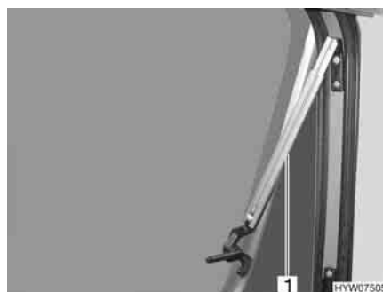
Fig. 36 Finestra apribile con deflettori automatici, aperta
