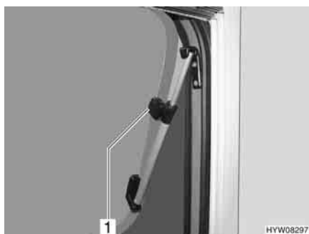
Fig. 35 Finestra apribile con deflettori a rotazione, aperta
