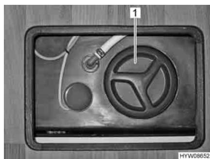
Fig. 111 Apertura per la pulizia sul serbatoio delle acque grigie (Mercedes-Benz)
