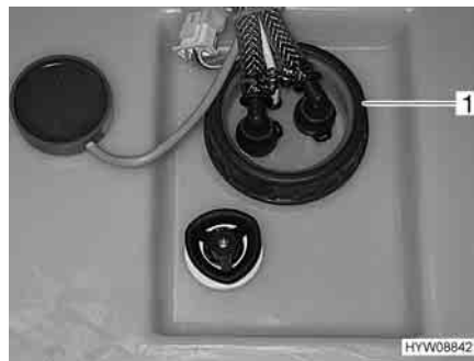
Fig. 110 Apertura per la pulizia sul serbatoio dell'acqua
