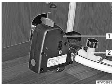
Fig. 109 Rubinetti di scarico e valvola di sicurezza/di scarico
