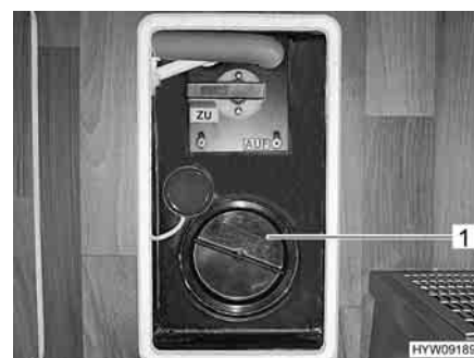
Fig. 112 Apertura per la pulizia sul serbatoio delle acque grigie (Fiat)
