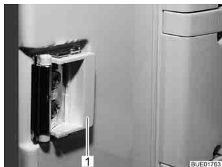
Fig. 145 Dispositivo di chiusura in posizione normale
