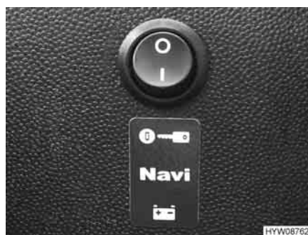
Fig. 93 Selettore della modalità operativa
