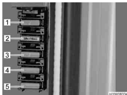
Fig. 101 Fusibili sul portafusibile
