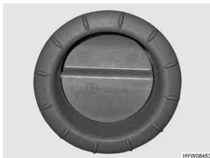
Fig. 107 Bocchetta di uscita dell'aria del riscaldamento ad aria calda
