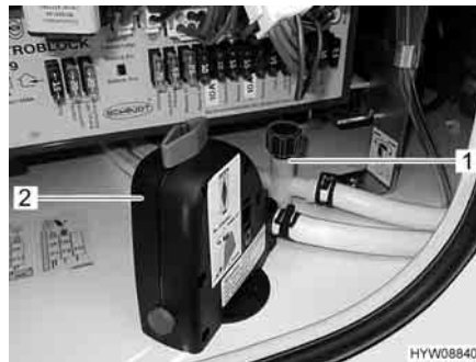
Fig. 167 Rubinetti di scarico e valvola di sicurezza/di scarico (Truma)
