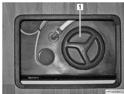
Fig. 170 Apertura per la pulizia sul serbatoio delle acque grigie
