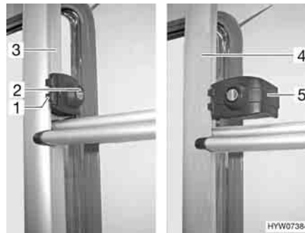
Fig. 2 Bloccaggio della scaletta del portapacchi
