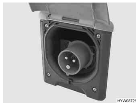
Fig. 98 Collegamento a 230 V sul veicolo
