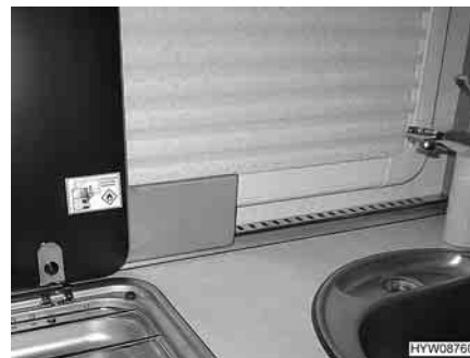
Fig. 131 Lastra proteggifiamma, copertura del fornello alzata
