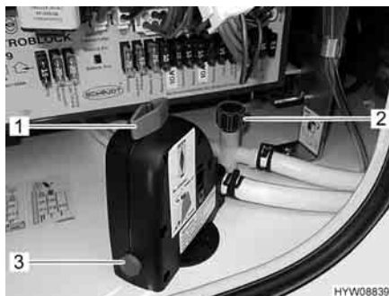
Fig. 152 Rubinetti di scarico e valvola di sicurezza/di scarico (Truma)
