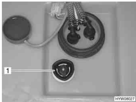
Fig. 155 Serbatoio dell'acqua con maniglia girevole
