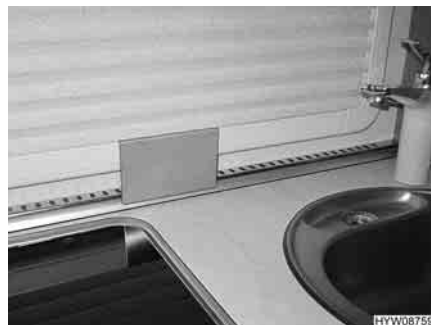
Fig. 13 Lastra proteggifiamma, agganciata al telaio della finestra
