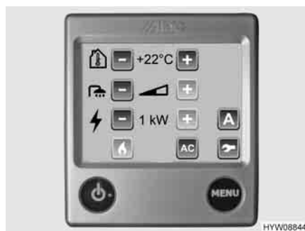
Fig. 113 Menu delle impostazioni per il riscaldamento ad acqua calda
