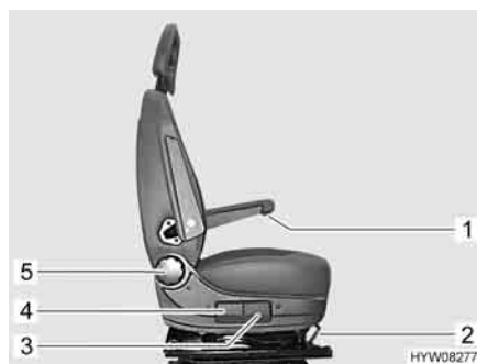
Fig. 20 Elementi di comando sul sedile
