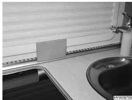
Fig. 130 Lastra proteggifiamma, agganciata al telaio della finestra
