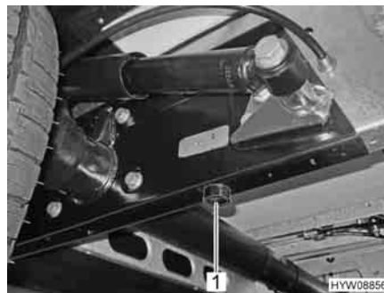
Fig. 188 Punto posizionamento cric (asse posteriore)
