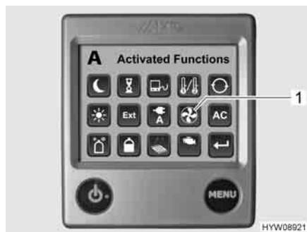
Fig. 117 Indicazione delle funzioni attivate
