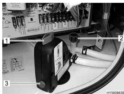
Fig. 127 Valvola di sicurezza/di scarico del boiler
