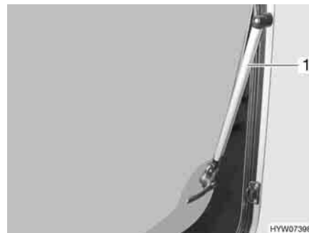
Fig. 36 Finestra apribile con deflettore automatico
