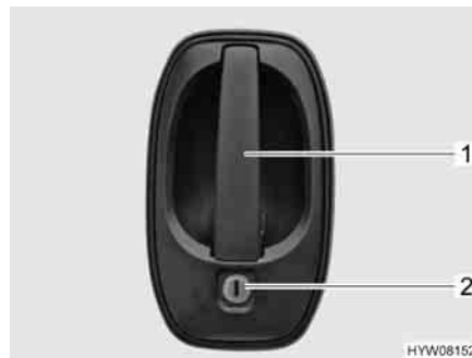
Fig. 30 Serratura della porta di ingresso, lato esterno
