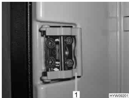
Fig. 147 Dispositivo di chiusura (alternativa) in posizione normale
