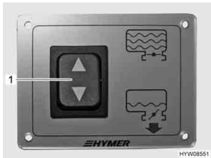
Fig. 158 Interruttore di comando per rubinetto di scarico
