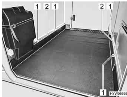
Fig. 3 Occhielli di ancoraggio garage di coda
