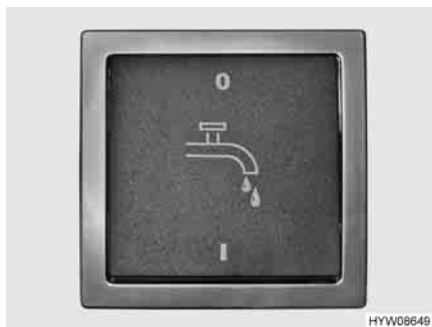
Fig. 151 Interruttore per pompa dell'acqua
