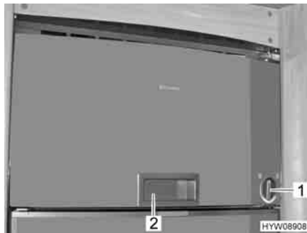
Fig. 132 Forno a gas integrato al frigorifero
