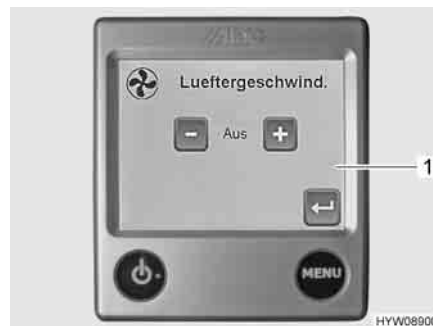
Fig. 117 Comando della ventola aggiuntiva
