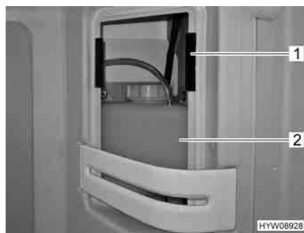
Fig. 182 Vaso d'espansione del riscaldamento ad acqua calda
