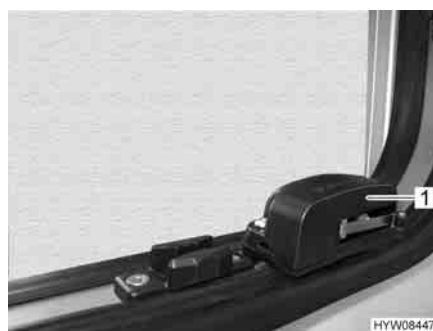
Fig. 110 Interruttore di sicurezza (vista dall'esterno)
