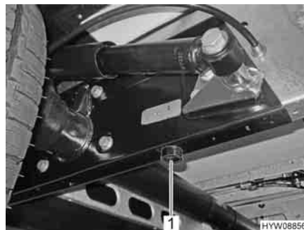
Fig. 190 Punto posizionamento cric (asse posteriore)
