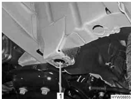
Fig. 189 Punto posizionamento cric (asse anteriore)
