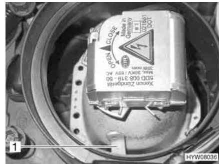
Fig. 177 Conversione fari anteriori (fari Xenon)
