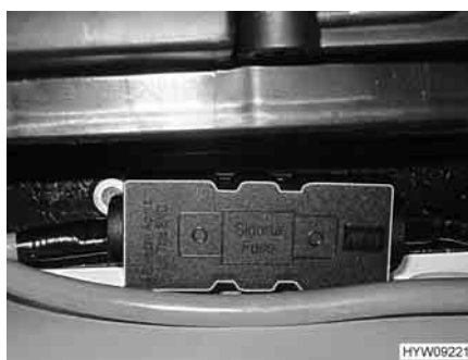
Fig. 114 Fusibile motore dell'impianto idraulico (150 A)
