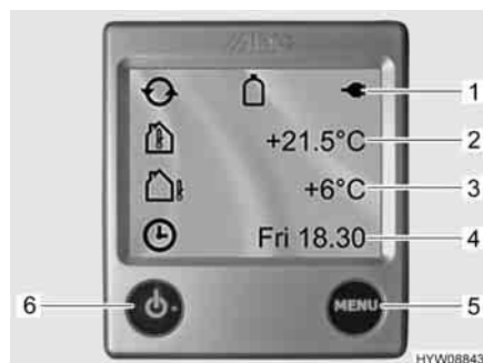
Fig. 124 Centralina di controllo, visualizzazione in stato di inattività
