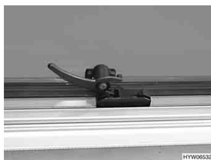
Fig. 54 Leva di serraggio in posizione "Aerazione continua"
