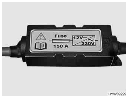
Fig. 116 Fusibile invertitore (150 A)
