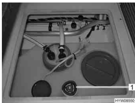
Fig. 152 Serbatoio dell'acqua con maniglia girevole
