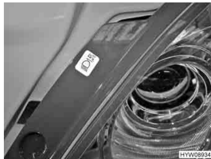
Fig. 178 Etichetta valori di inclinazione sull'alloggiamento fari
