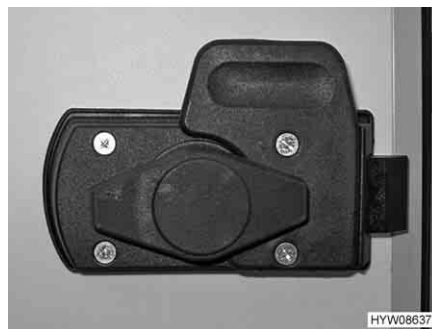
Fig. 20 Serratura della porta, lato interno, aperta
