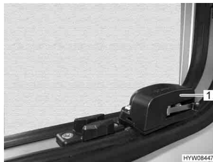
Fig. 103 Interruttore di sicurezza (vista dall'esterno)
