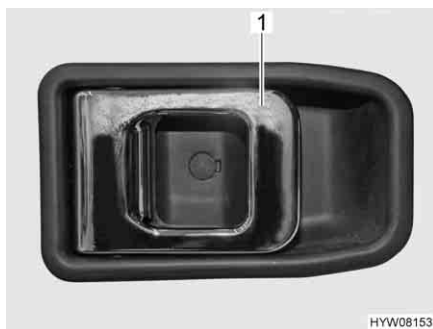
Fig. 25 Serratura della porta di ingresso, lato interno
