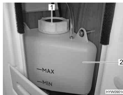
Fig. 153 Vaso d'espansione del riscaldamento ad acqua calda (vano doccia)
