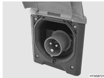
Fig. 80 Collegamento a 230 V sul veicolo
