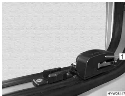
Fig. 165 Interruttore di sicurezza (vista dall'esterno)
