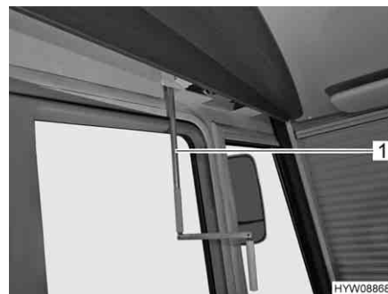
Fig. 76 Manovella per esercizio di emergenza (pronta all'uso)
