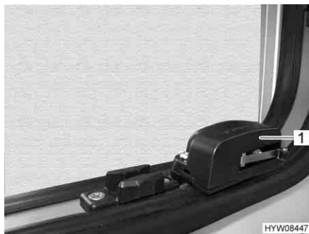
Fig. 144 Interruttore di sicurezza (vista dall'esterno)
