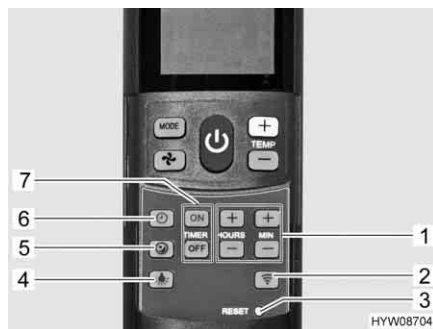
Fig. 145 Telecomando con tasti di impostazione
