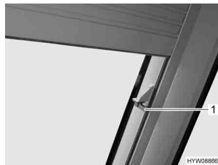
Fig. 55 Chiusura di sicurezza aggiuntiva oscurante a rullo
