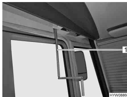
Fig. 59 Manovella per esercizio di emergenza (pronta all'uso)
