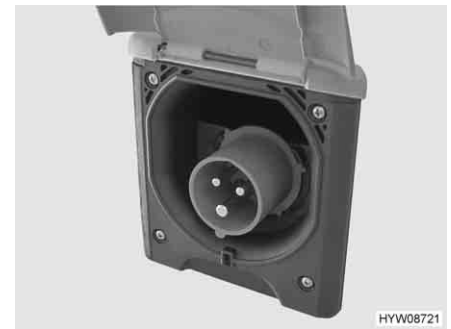
Fig. 106 Collegamento a 230 V sul veicolo
