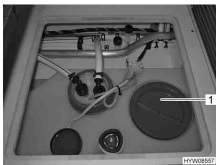
Fig. 156 Apertura per la pulizia del serbatoio dell'acqua
