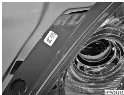
Fig. 195 Etichetta valori di inclinazione sull'alloggiamento fari
