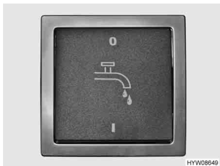
Fig. 163 Interruttore per pompa dell'acqua
