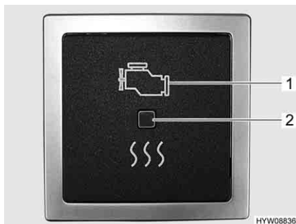
Fig. 139 Interruttore di comando pompa di circolazione aggiuntiva
