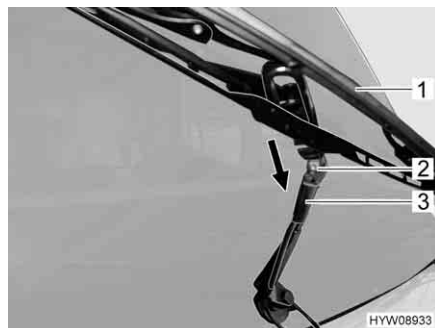
Fig. 187 Sostituzione delle spazzole del tergicristallo
