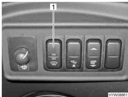
Fig. 9 Interruttore a bilico per riscaldamento del parabrezza
