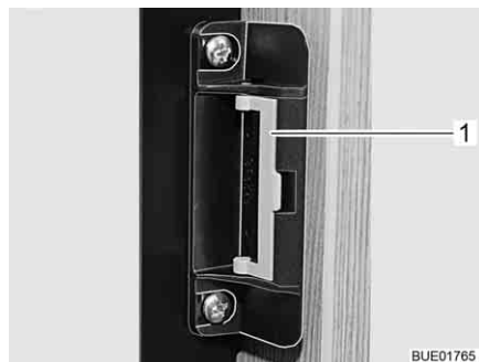
Fig. 161 Dispositivo di chiusura in posizione normale
