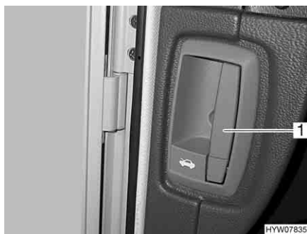
Fig. 35 Leva di sbloccaggio cofano motore
