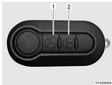
Fig. 45 Telecomando chiusura centralizzata
