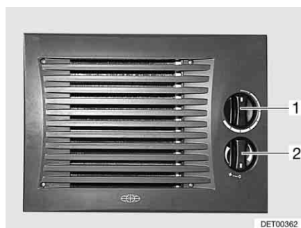
Fig. 143 Elementi di comando dello scambiatore di calore aggiuntivo
