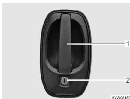
Fig. 48 Serratura della porta conducente/porta di ingresso, lato esterno
