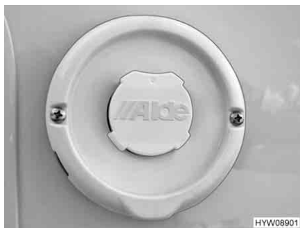
Fig. 141 Camino da parete del riscaldamento ad acqua calda
