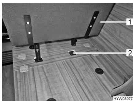
Fig. 26 Inserire il sedile installabile nel supporto
