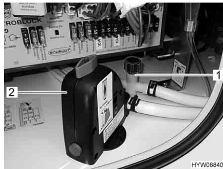
Fig. 179 Rubinetti di scarico e valvola di sicurezza/di scarico (Truma)
