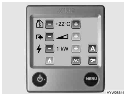
Fig. 135 Menu delle impostazioni per il riscaldamento ad acqua calda
