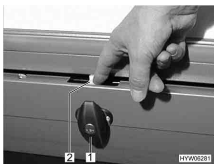
Fig. 55 Sicurezza della serratura gavone estraibile sottopavimento
