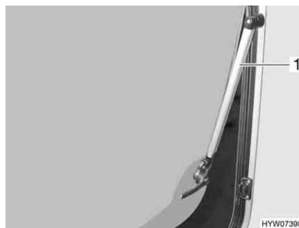
Fig. 58 Finestra apribile con deflettore automatico
