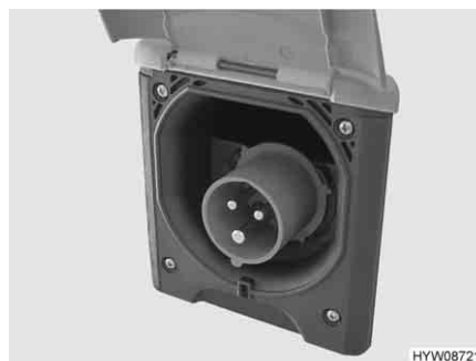
Fig. 118 Collegamento a 230 V sul veicolo
