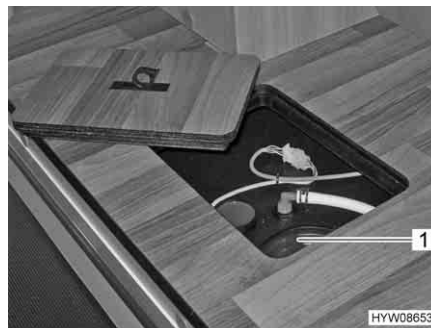
Fig. 183 Apertura per la pulizia sul serbatoio delle acque grigie (alternativa)
