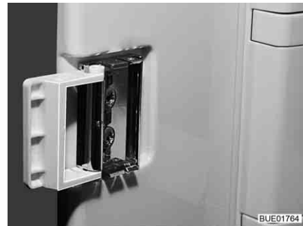
Fig. 160 Dispositivo di chiusura in posizione di ricircolo d'aria
