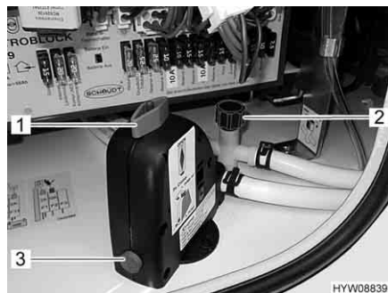
Fig. 164 Rubinetti di scarico e valvola di sicurezza/di scarico (Truma)
