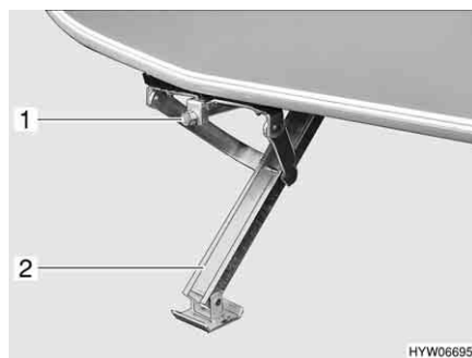
Fig. 10 Piedini di stazionamento a manovella abbassati
