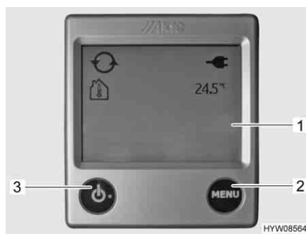
Fig. 77 Centralina di controllo, schermata iniziale per riscaldamento ad acqua calda
