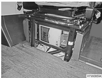
Fig. 51 Ubicazione scatola dei fusibili a 230 V (Serengeti)
