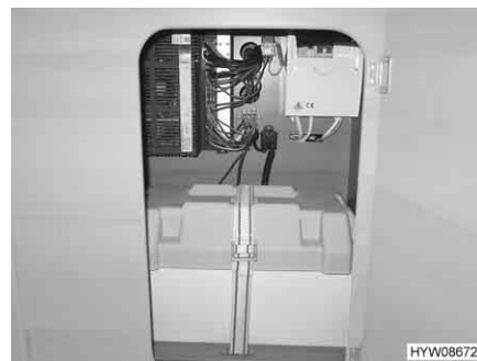
Fig. 52 Ubicazione scatola dei fusibili a 230 V (Grand Canyon, Yellowstone)
