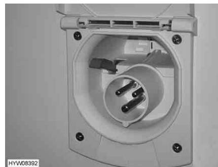
Fig. 58 Collegamento a 230 V sul veicolo
