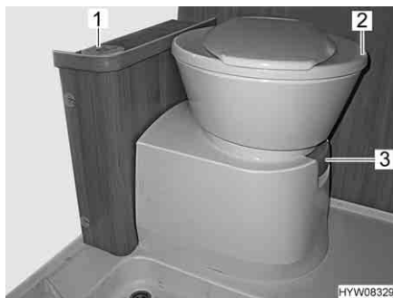
Fig. 153 Tazza del WC con centralina di controllo e di comando
