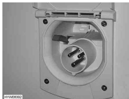
Fig. 85 Collegamento a 230 V sul veicolo
