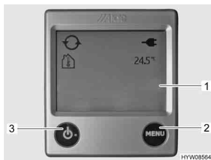
Fig. 65 Centralina di controllo, schermata iniziale per riscaldamento ad acqua calda
