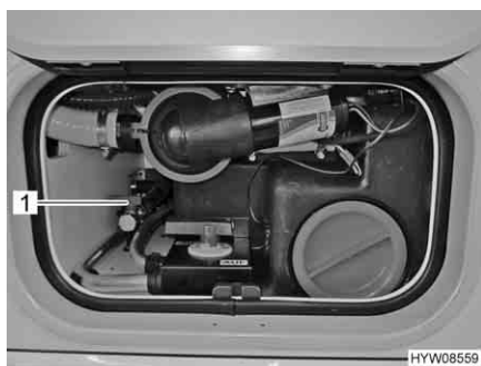
Fig. 120 Attacco per liquido del circuito di riscaldamento
