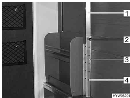
Fig. 75 Letto in coda, abbassabile meccanicamente
