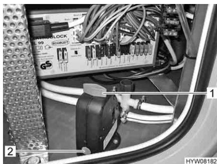
Fig. 129 Valvola di sicurezza/di scarico del boiler
