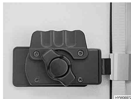
Fig. 24 Serratura della porta, lato interno, bloccata
