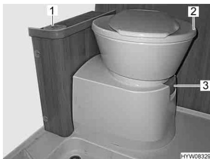
Fig. 162 Tazza del WC con centralina di controllo e di comando
