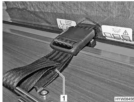
Fig. 8 Bloccaggio finestra panoramica
