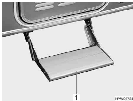
Fig. 9 Scalino di ingresso (integrato)
