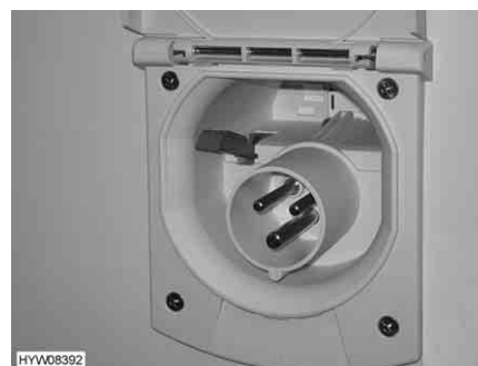
Fig. 54 Collegamento a 230 V sul veicolo
