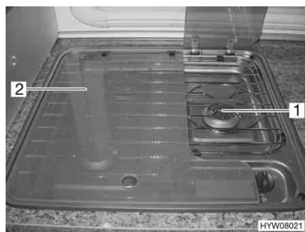
Fig. 80 Copertura del fornello a gas
