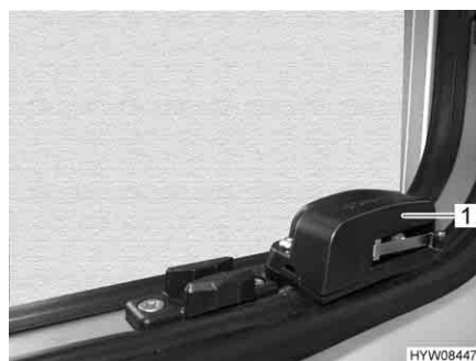
Fig. 67 Interruttore di sicurezza (vista dall'esterno)
