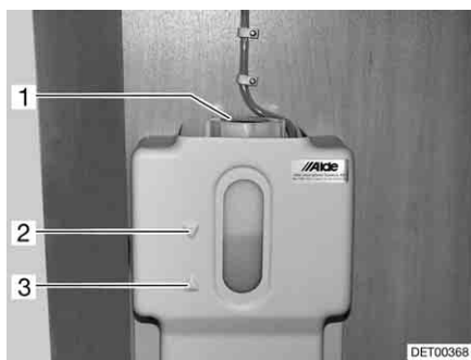
Fig. 102 Vaso d'espansione del riscaldamento ad acqua calda
