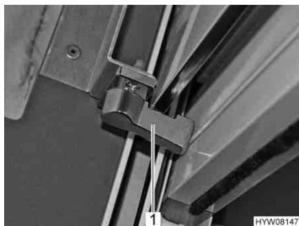
Fig. 21 Chiusura di sicurezza oscurante a rullo
