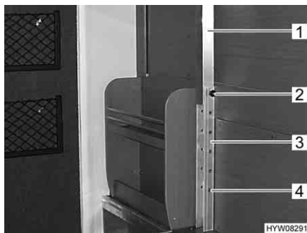
Fig. 76 Letto in coda, abbassabile meccanicamente
