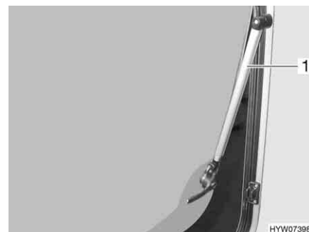
Fig. 48 Finestra apribile con deflettore automatico
