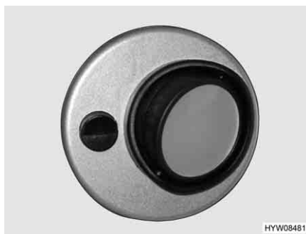
Fig. 179 Luce di lettura con LEDs
