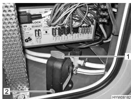
Fig. 131 Valvola di sicurezza/di scarico del boiler
