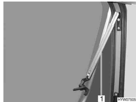
Fig. 35 Finestra apribile con deflettori automatici, aperta
