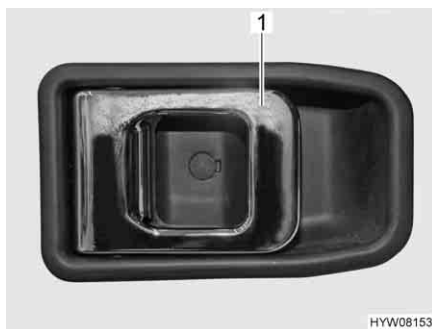
Fig. 18 Serratura della porta di ingresso, lato interno
