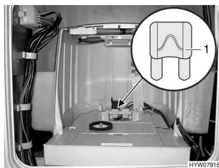
Fig. 118 Fusibile della toilette Thetford
