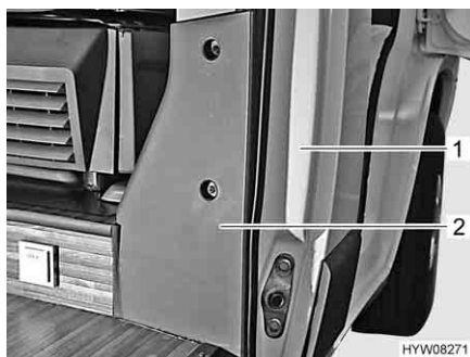
Fig. 45 Copertura box relè AD01
